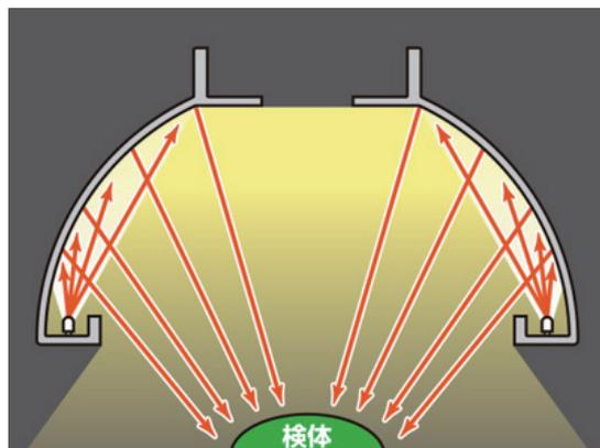
高輝度白色LEDをドームの内側に向けて照射し、乱反射させることによって均一拡散光を作り出します。
