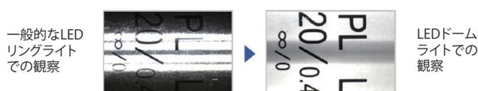
一般的なLEDリングライトでは光源の写り込みの白とび、黒つぶれを起こしていた光沢曲面の撮影も、LEDドームライトを利用することで明瞭な像を得ることができます。
