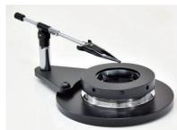
宝石の鑑定 (インクルージョン検査) 等で用いる照明装置。顕微鏡の円形ステージに替えて使用します。宝石クリップ付
