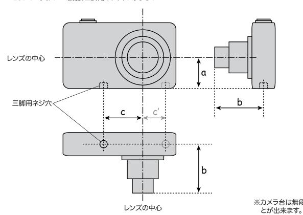
デジタルカメラアダプタASH860のカメラ台の可動範囲を示します。 プリントアウト後、図の上にカメラを実際に置き、接続が可能かどうか をお確かめ下さい。
