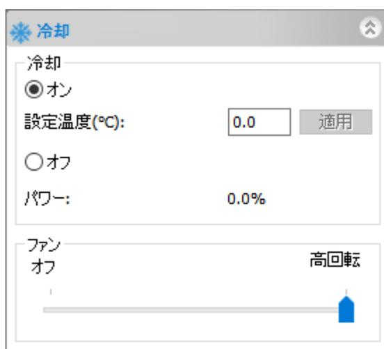
WRAYCAM-ALASKA/CIX 接続時にのみ表示されます。カメラ内部を冷却し低温に保つことで、高感度・低ノイズの顕微鏡撮影が可能です。
