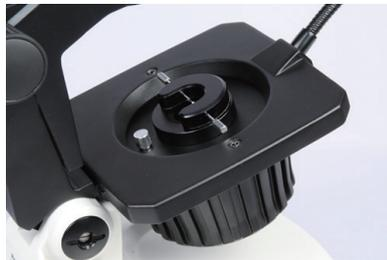
試料を左右から挟み込んで固定します。顕微鏡下に試料を水平に設置し、回転させてながら観察できます。標本クリップでは把持部が試料に重なりが観察しにくい場合がありますが、本製品はそれを解決します。ダイヤモンドのプロポーシオン・パピリオンの鑑定などにご利用いただけます。
