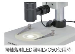
同軸落射LED照明LVC50使用時
