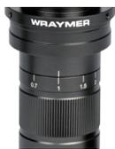
ズーム調整環にはクリックストップ機構を搭載。無段階ズームでありながら、0.7倍・1倍・2倍・3倍・4倍・5倍・5.6倍の目盛位置でカチッと止まるため、任意の倍率での観察と倍率の再現性を両立しています。常に同じ倍率での観察を求められる検査用途などに便利です。ズーム鏡筒部のズーム調整環を回すことにより、ズーム倍率を設定出来ます。ズーム倍率は無段階に変更することが出来ます。ズームレンジは0.7倍～5.6倍で、ズーム比は8倍です。
