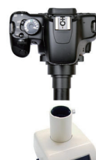
ニコン旧式顕微鏡の撮影鏡筒(V-T写真真筒)への取り付け
