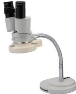
・ 360°回転可能な鏡筒とフレキシブルアームにより、作業姿勢に適した顕微鏡の位置付けが可能です。
