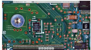
また、レイヤーモードでは較正(キャリブレーション)の情報を撮影した静止画内に保存出来ます。画像データに撮影時の較正データが保存されているので、時間が経ったあとに計測作業を行ったり、再計測を行うことが出来ます。
