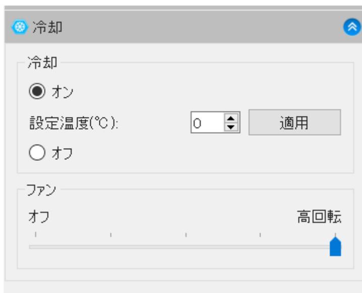
WRAYCAM-CIX2000 および WRAYCAM-ALASKA 接続時にのみ表示されます。カメラ内部を冷却し低温に保つことで、高感度・低ノイズの顕微鏡撮影が可能です。
