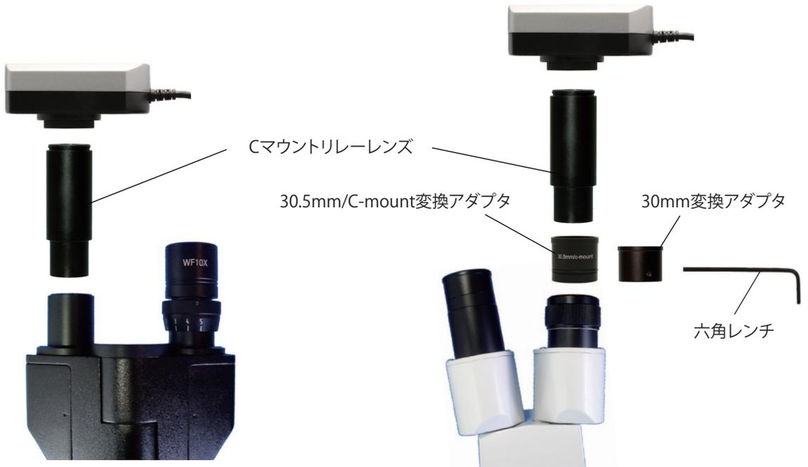
鏡筒内径が23.2mmの顕微鏡に接続する場合は、Cマウントリレーレンズを介して取り付けます。
