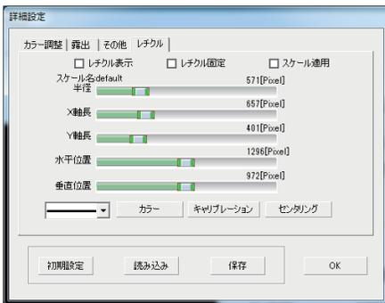
○レチクル表示：プレビュー画面にレチクルを表示します。円半径やX軸長・Y軸長を設定するとレチクル表示が選択可能になります。
